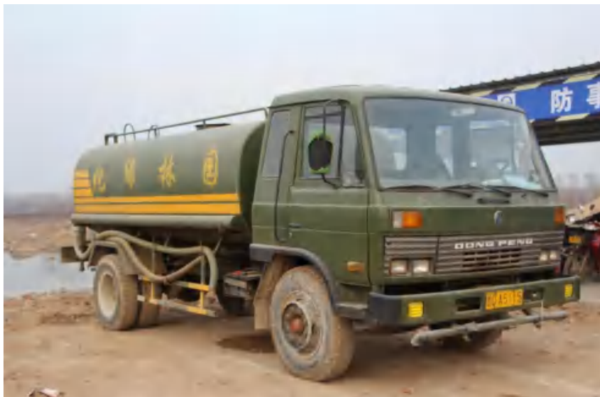
图4-3 施工场地洒水抑尘
